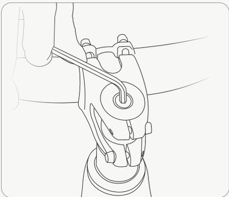
1. Retire la cubierta de plástico del juego de dirección de la potencia de la bicicleta.
