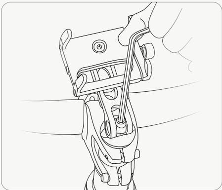
3. Fíjalo con una llave (la inclinación del soporte del teléfono puede ajustarse cuando el tornillo de fijación está suelto, y se fijará después de apretarlo)
