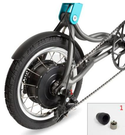
En el eje de la rueda trasera encontrarás un tapón de goma y en su interior un pequeño interruptor metálico que se inserta en el eje. Tener cerrado la clavija de conexión con el tapón es imprescindible para poder activar el sistema eléctrico.
