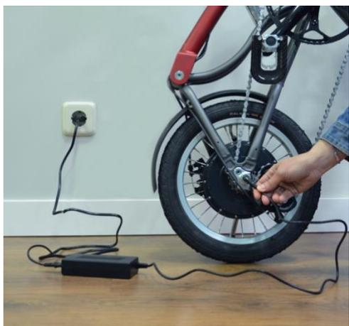
Se recarga con el cargador (proporcionado con la compra de la bicicleta) enchufándolo en cualquier toma eléctrica. Para conectarlo a la bicicleta es necesario retirar el protector de goma y el pequeño interruptor metálico situado en el centro del eje de la rueda trasera simplemente tirando de ellos hacia fuera. Una vez liberada la conexión
